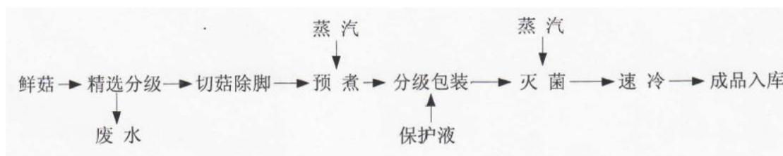
图 3.2-7 蘑菇罐头生产工艺
